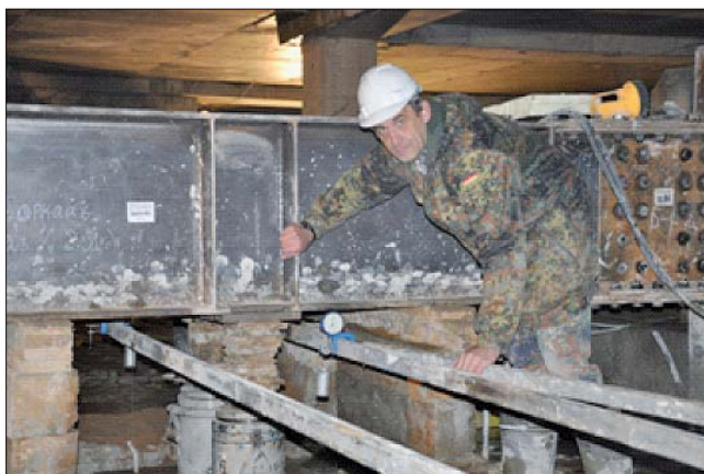
Рис. 9. Проведение статических испытаний
